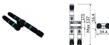
Micro derivatore 3 vie 2M+1F 10A 2 poli 0,25-1,5mm 2 (23-16AWG) Øcavo 5,8-6,9mm (0,23-0,27") - IP68
