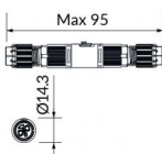
Micro-connecteur 10A 2 pôles 0,25-1,5 mm 2 (23-16AWG) Ø câble 5,8-6,9 mm (0,23-0,27") - IP68
